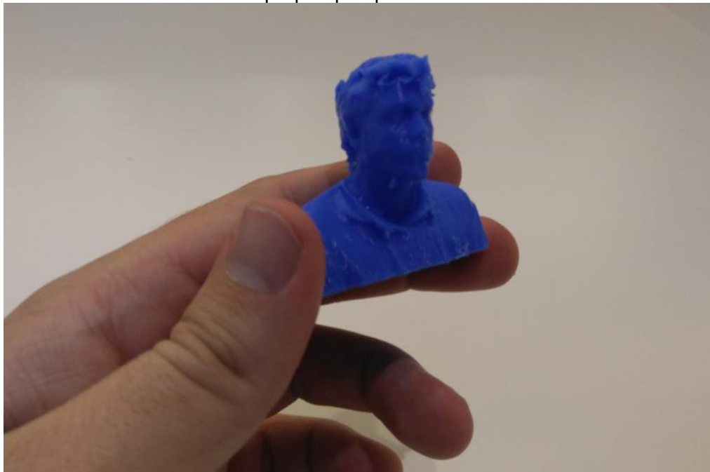
Foto 02. Uso de Impressora 3D para fabricação de protótipo com formas escaneadas do próprio pesquisador.
