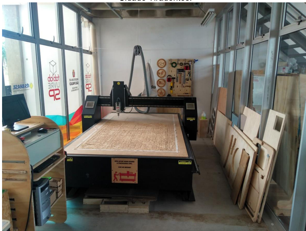
Foto 31. Fresadora CNC de Grande Formato no Fab Lab Centro de Formação Cultural Cidade Tiradentes.
