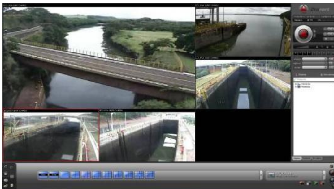
Figura 28 - Sistema de monitoramento de uma eclusa
