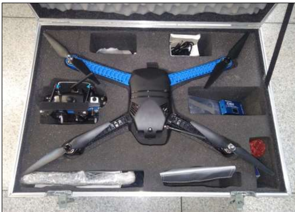
Figura 9. Veículo aéreo não tripulado – VANT modelo Iris+ 3D Robotics, utilizado para o mapeamento de bancos de macrófitas aquáticas na bacia hidrográfica do rio Itanhaém, Itanhaém – SP.
