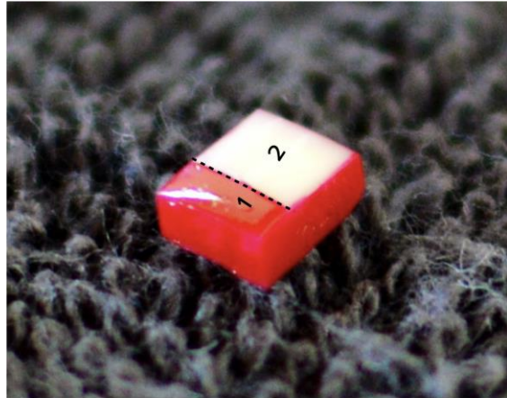
1/3 do bloco protegido com verniz ácido-resistente
