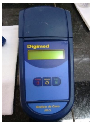
Figura 16 - Colorímetro para medição de Cloro
