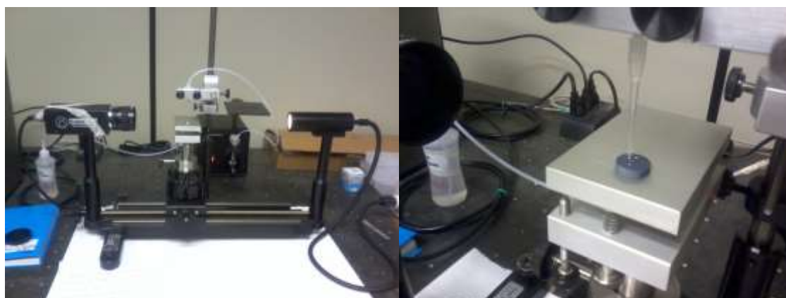
Figura 1 – Célula Eletroquímica para anodização
