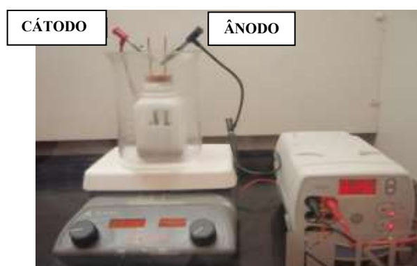
Figura 1 – Célula Eletroquímica para anodização
