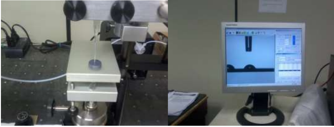
Figura 3 - Equipamento empregado para medida do ângulo de contato (Goniômetro)
