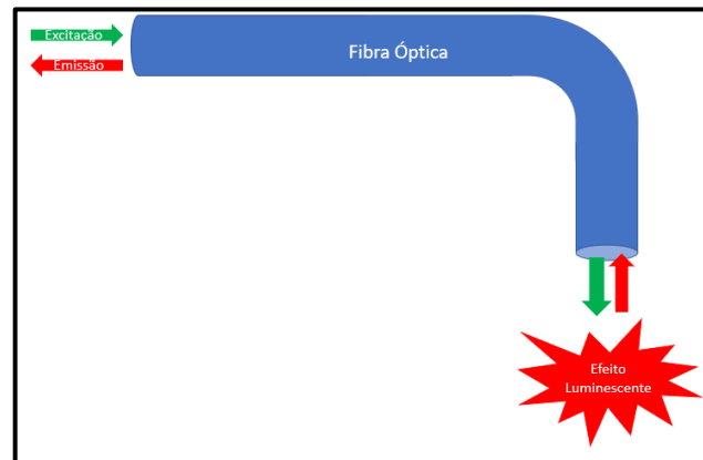
Figura 35 – Esquema de uma fibra óptica utilizada como parte de um sensor.
