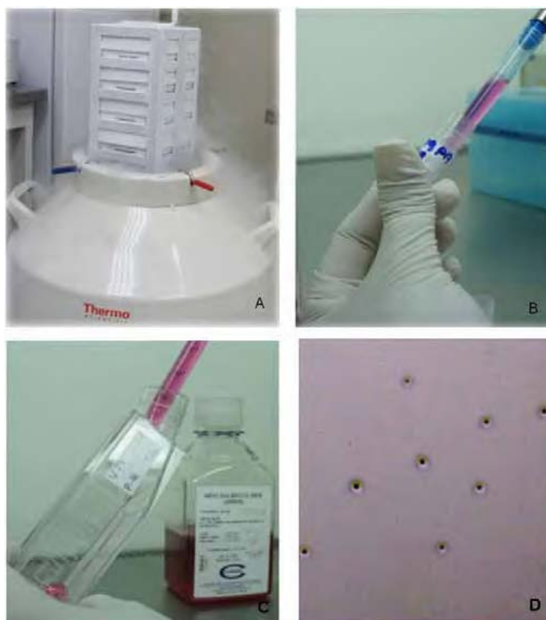
Figura 2 - A) caixas removidas do tambor de nitrogênio; B) células sendo removidas do tubo criogênico; C) frasco de cultura; D) verificação da presença de células.
