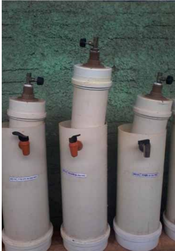
Figura 5. Biodigestor modelo batelada de bancada (Capítulo 3 e 4).
