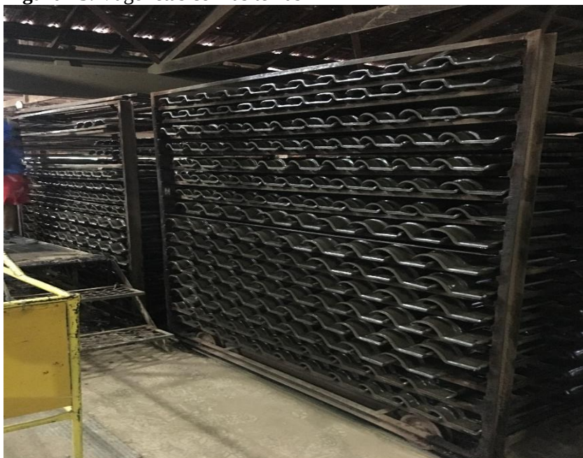
Figura 15. Vagonetas com as telhas
