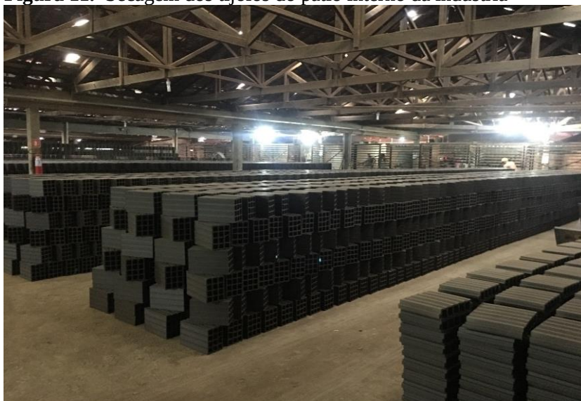
Figura 11. Secagem dos tijolos do pátio interno da indústria
