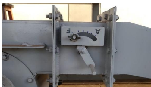
Figura 13. Dispositivo que controla a entrada de vazão de ar na câmara de combustão
