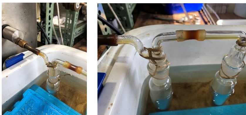
Figura 17. Saída de gases e bio-óleo do reator
