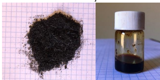
Figura 33. Carbonizado e bio-óleo obtidos através do processo de pirólise lenta com biomassa de cana-de-açúcar.
