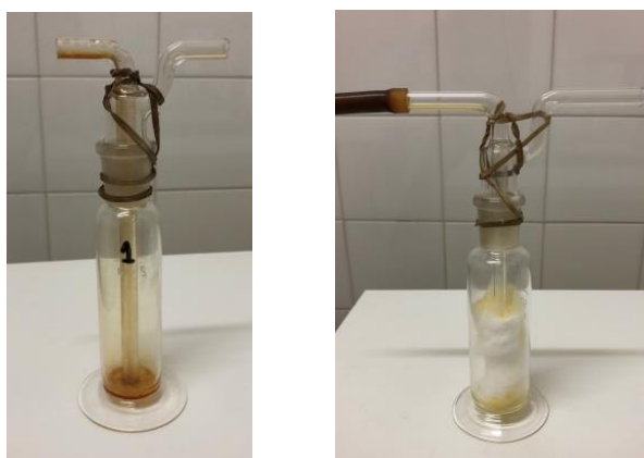
Figura 32. Primeiro (a) e último (b) condensador do sistema de coleta de óleo
