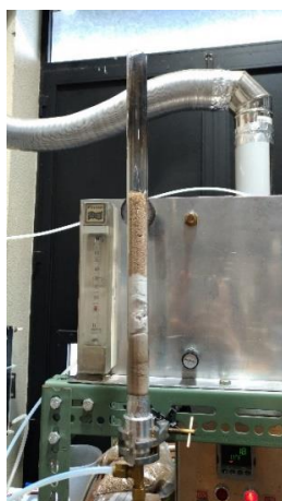
Figura 16. Reator de pirólise com a biomassa disposta na zona de aquecimento (10 cm)
