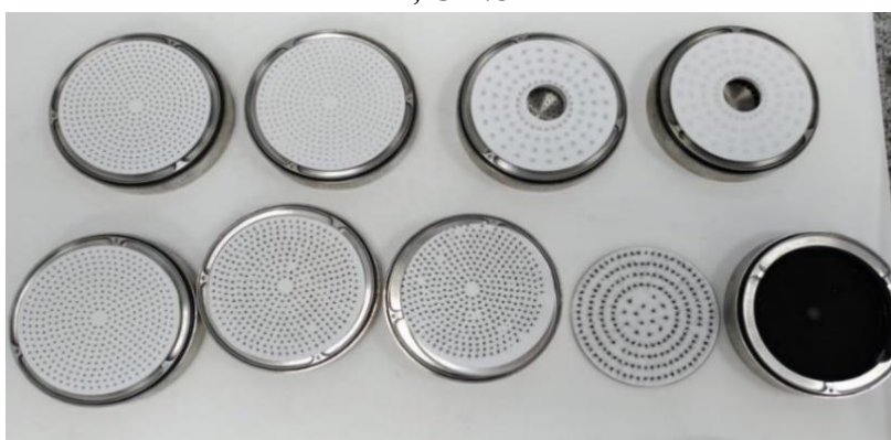
Figura 22. Material particulado coletado com 5 minutos de duração para uma velocidade de v = 4,19 \text{ m/s}
