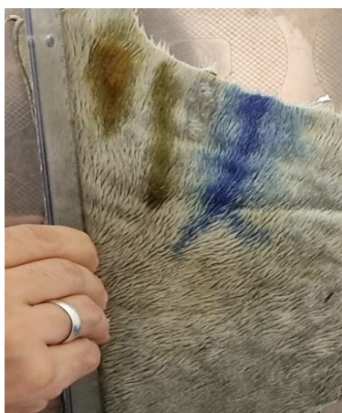
Figura 31. Teste de determinação da velocidade de escoamento de formulações em couro bovino. (Fonte: Rafaela Fantatto).
