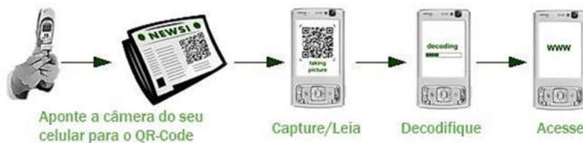
Figura 7 – Instrução do processo de leitura de um QRCode via dispositivo móvel
