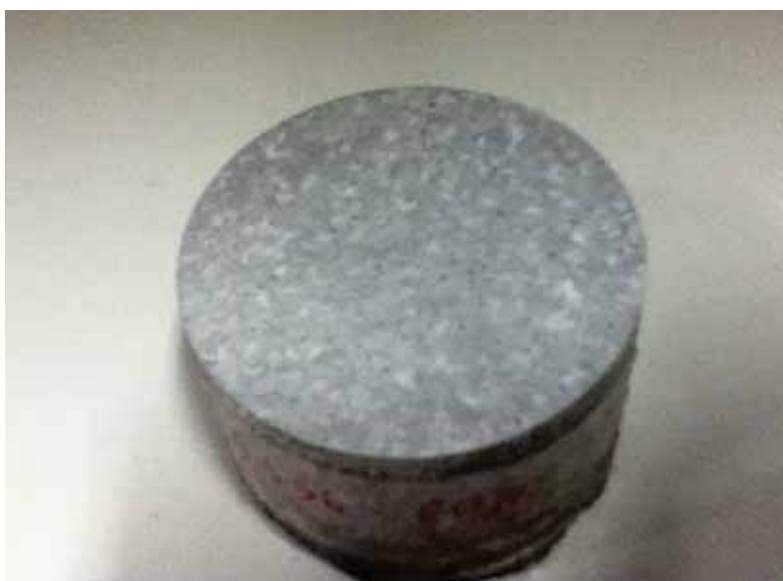
Figura 14: Macrografia no lingote molde de areia
