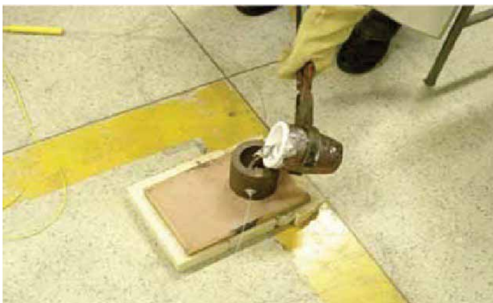
Figura 9: Vazamento de metal líquido
