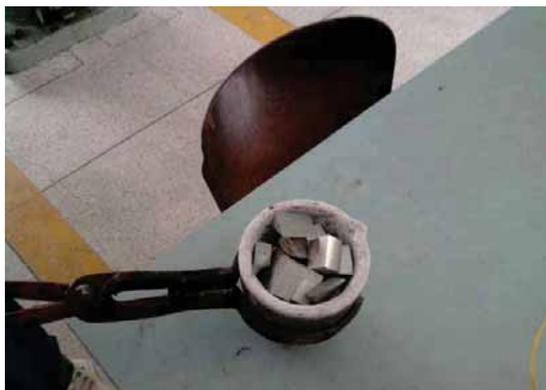
Figura 5 : Cadinho preenchido com material a ser estudado (liga AA356)
