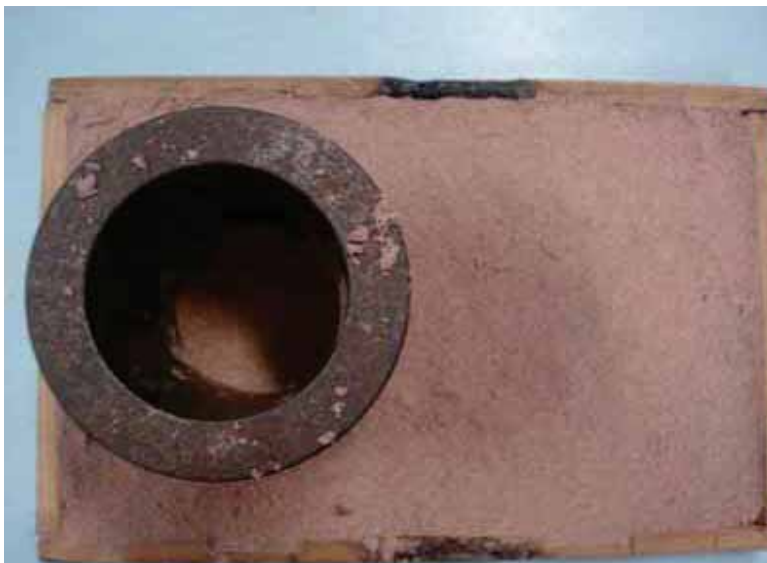
Figura 7: Molde metálico posicionado para vazamento
