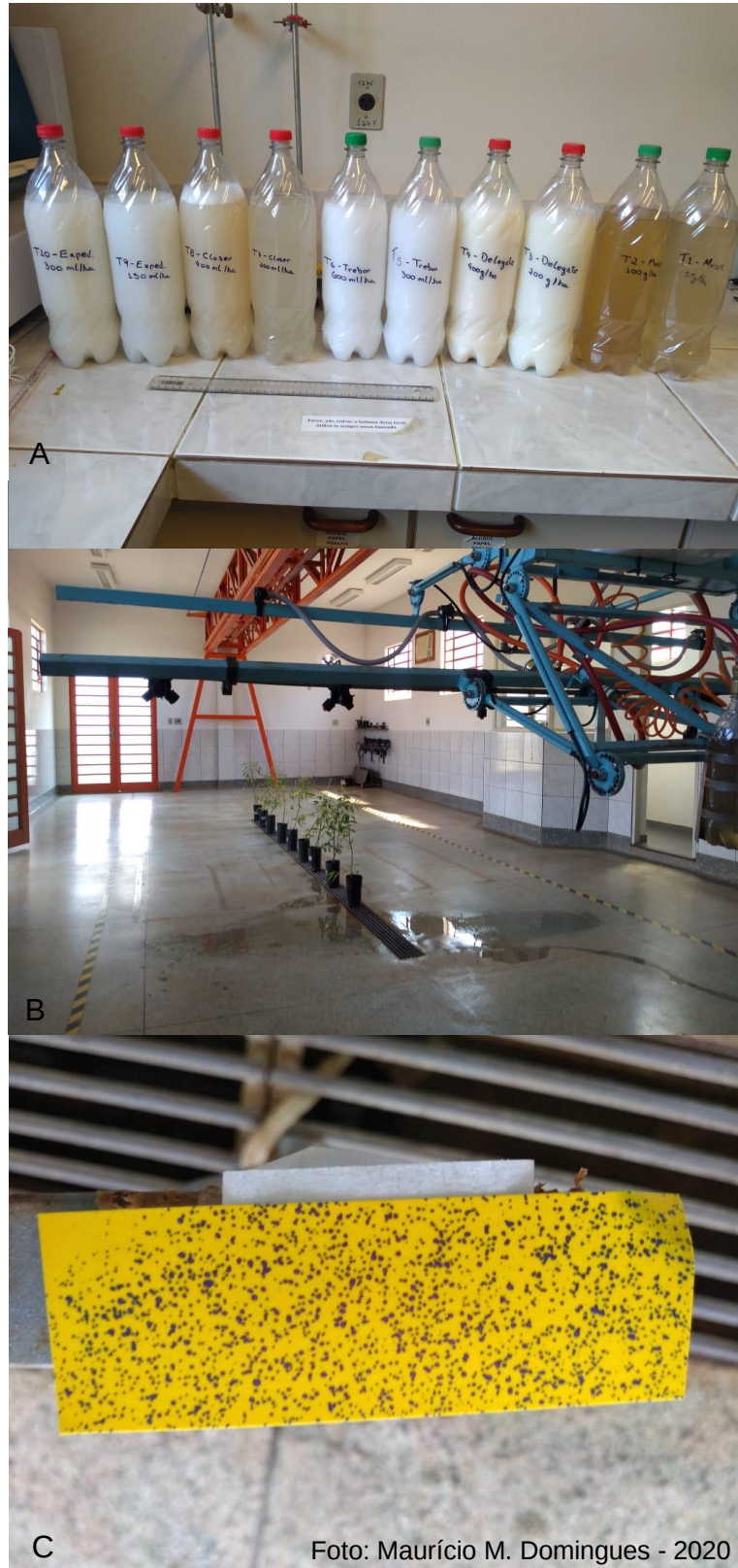
Figura 2 - Preparação das caldas inseticidas para aplicação no simulador de barra estacionária (A), aplicação dos tratamentos com o simulador de barra estacionária (B) e cobertura de aplicação dos produtos (C)
