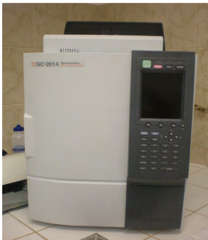
Figura 3: Cromatógrafo gasoso Shimadzu GC 2014, acoplado com software GC Solution com uma coluna Restec modelo Rtx ® - 1301, 60m X 0,25mm. Fonte: imagem da autora, 08/01/2010, UNESP Jaboticabal, Laboratório de Tecnologia.
