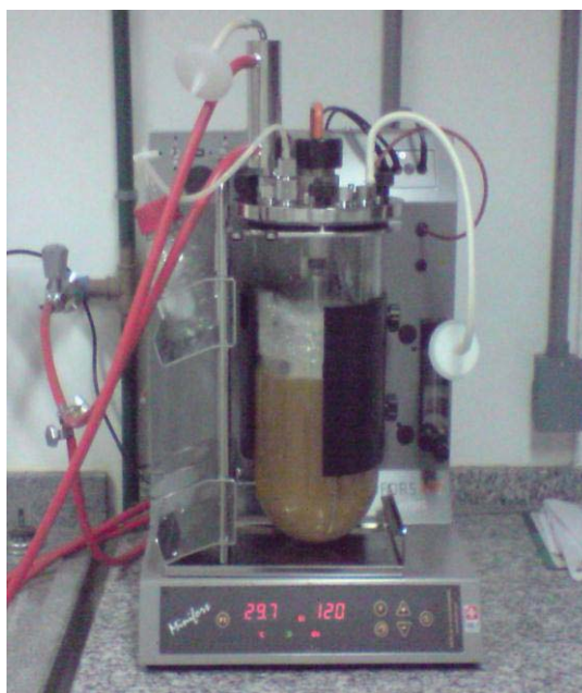
Figura 2: Crescimento da levedura Pichia pastoris em fermentador (INFORS HT-Minifors, capacidade 5L)
