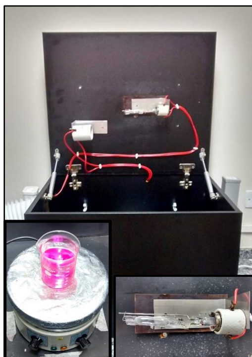
Figura 15 - Reator fotocatalítico composto por uma de 125 W de vapor de mercúrio sem o bulbo e um agitador magnético.
