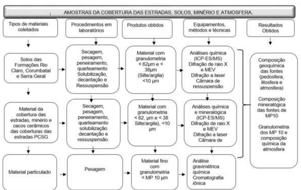
Figura 4.6 - Fluxograma dos trabalhos para preparação das amostras em laboratórios e seus respectivos métodos analíticos.
