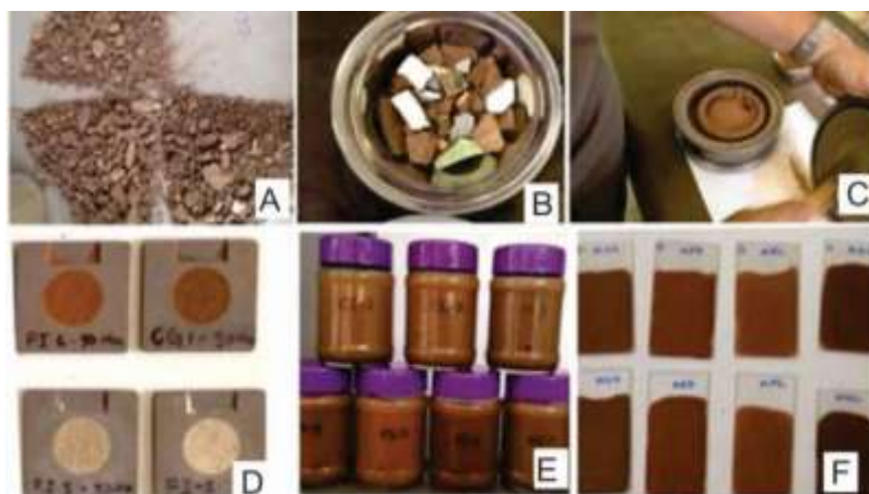
Figura 4.7 - Sequência de processos utilizados para redução granulométrica dos materiais coletados no piso das estradas. (A) quarteamento do material; (B) - cacos de pisos cerâmicos, após separação por peneiramento; (C) - Painela de ágata utilizada no moinho oscilante para redução granulométrica; (D) - Material separado para análise por difração de raios X (DRX); (E) - Material colocado para decantação e separação da fração fina; (F) - Laminas de vidro com o material fino para estudos de difração de raios X.
