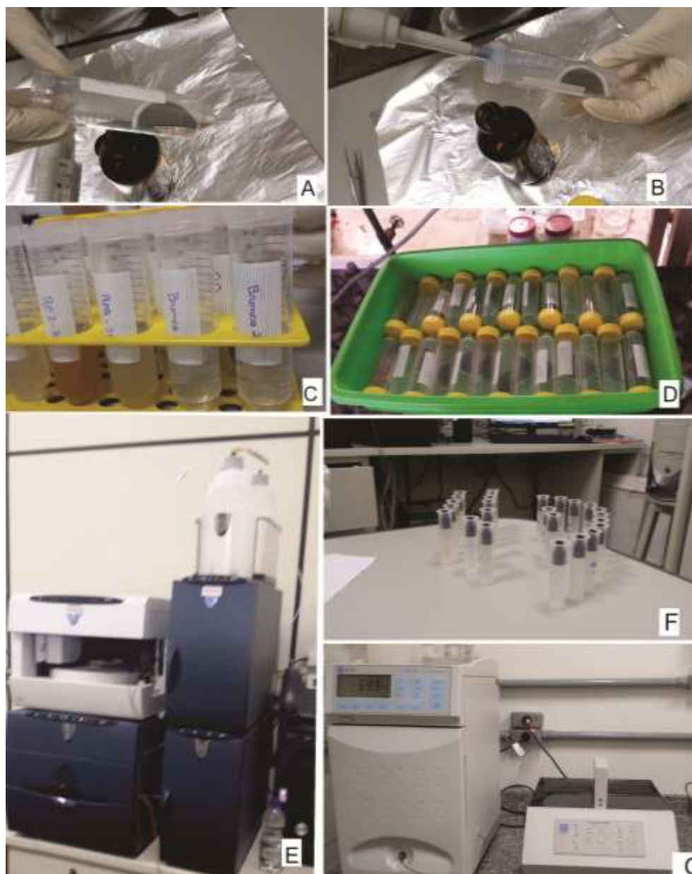
Figura 4.12 - Ilustração do processo de extração do material particulado coletado em filtros de teflon. (A e B)- Utilização de isopropanol para abertura das membradas dos filtros;(C) - Material colocado em falcon para extração dos íons solúveis; (D)- Mesa agitadora para auxiliar no processo de separação;(E) - cromatógrafo; (F)- Vial utilizado para fazer a leitura (G)- Cromatógrafo DIONEX. Fonte: Autora
