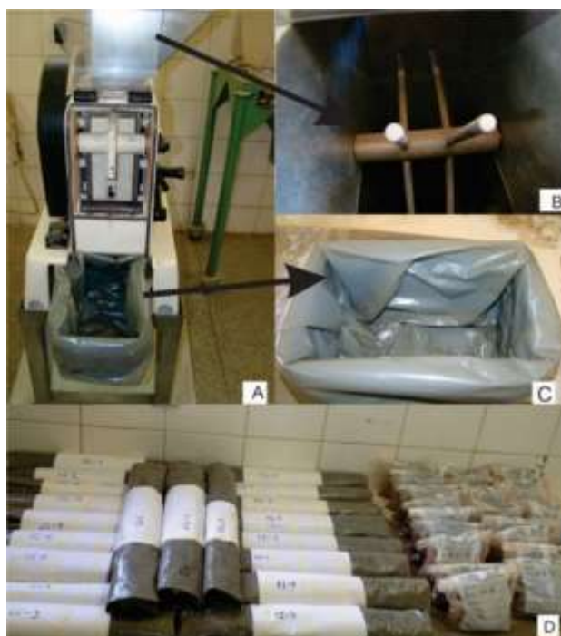
Figura 4.5 - Equipamentos e materiais utilizados nas etapas iniciais dos trabalhos laboratoriais. (A) -Britador tipo martelo; (B) - vista da parte interna do britador;(C) - Coletor de material britado; (D) - duplicata de material britado.
