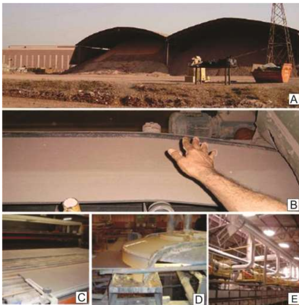
Figura 1.9 - Ilustração das etapas de produção de pisos e revestimentos cerâmicos (A)- Galpão típico construído nas proximidades das indústrias cerâmicas utilizadas para armazenagem da matéria prima seca; (B)- Detalhe de uma esteira transportando minério na linha de produção;(C) - Prensagem e moldagem dos pisos; (D)- Aplicação de engobe para posterior esmaltação da peça;( E) - Vista lateral dos fornos utilizados nos processos de queima dos materiais cerâmicos.
