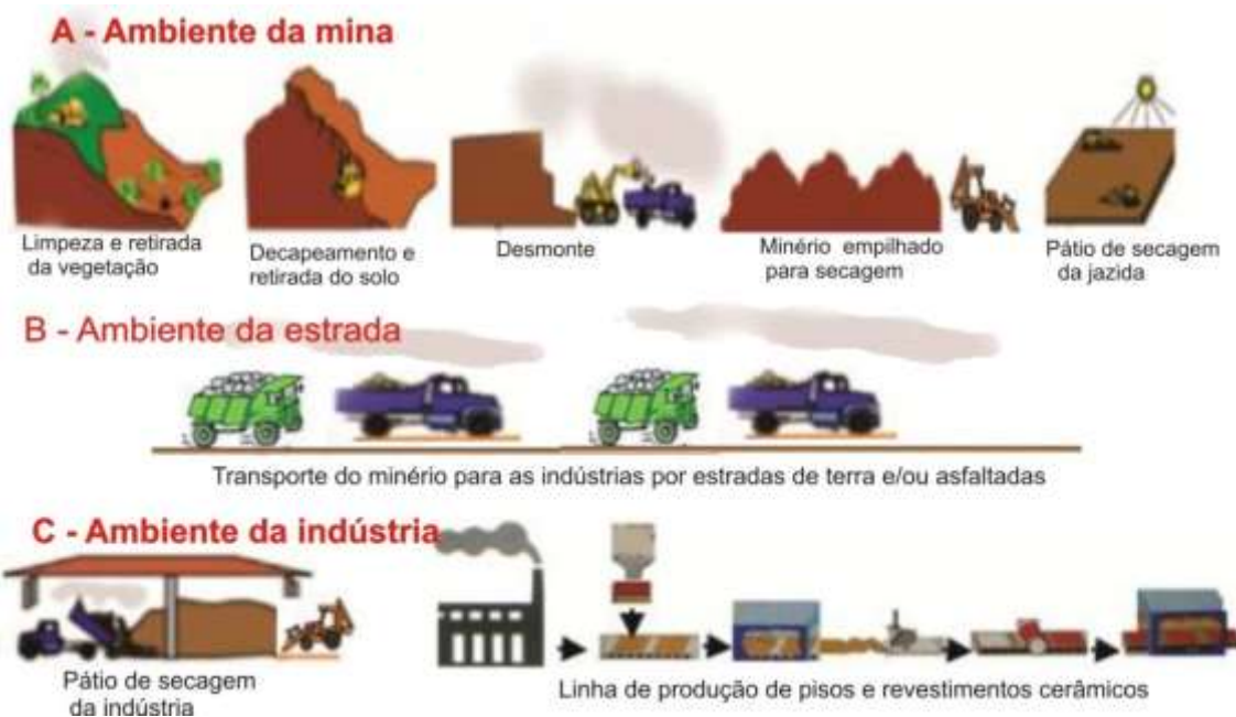
Figura 1.4 - Ilustração sumária dos três principais horizontes ou locais onde são causados danos ambientais nas esferas do ar, vida, solo e água; (A) - Nesse ambiente (da mina) temos o decapamento; retirada da camada de solo; extração e secagem de minério na frente de lavra; (B) - Processos desencadeado pelo transporte do minério da frente de lavra para as indústrias; (C) - Interior das fábricas e seus arredores onde o processo de produção também provoca danos ao meio ambiente. Fonte: Modificado do Relatório IPT (2005).
