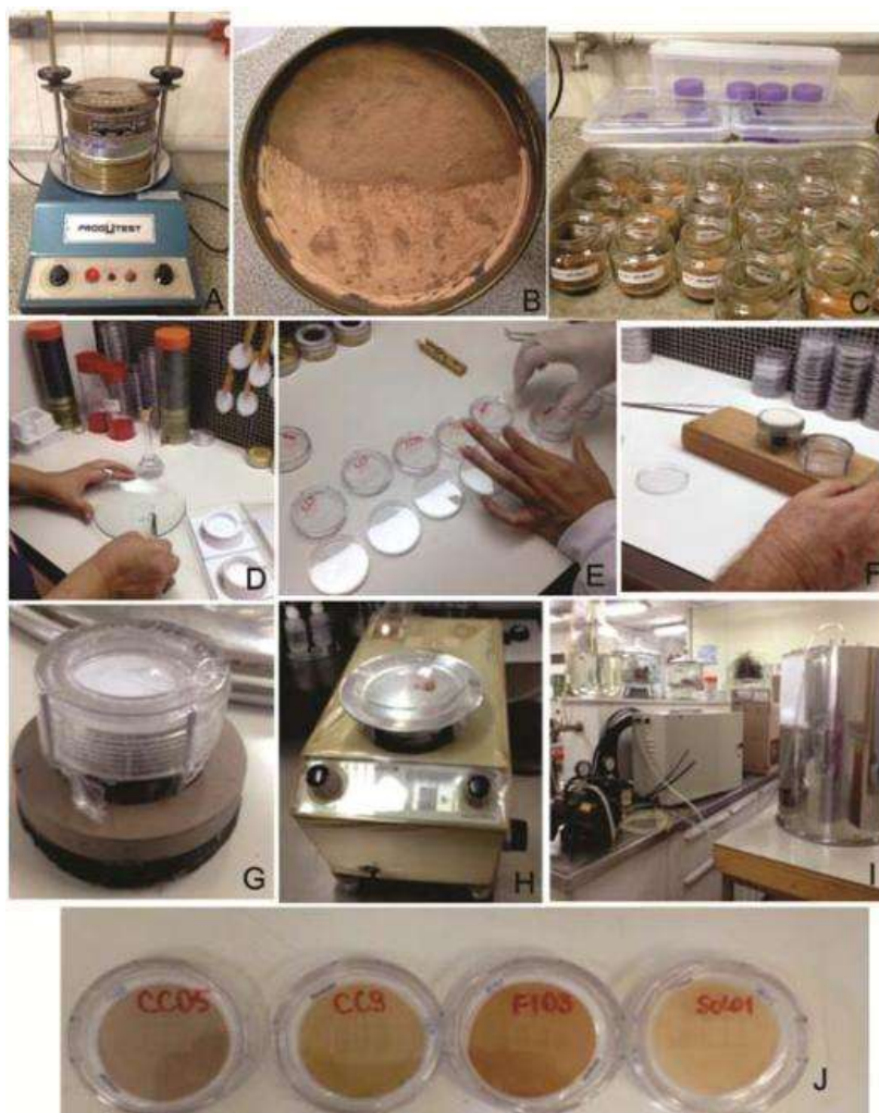
Figura 4.11 - (A) -Seqüência de procedimentos, materiais e equipamentos utilizados no laboratório de ressusensão da CETESB. Agitador de peneiras; (B) - Prato do agitador contendo material com granulometria abaixo de 400 \mu m; (C) - Frascos de vidro contendo materiais para secar; (D e E) - Filtros de teflon sendo preparados em solução de nujol ; (F e G) - Suporte para colocação do filtro em câmara de ressusensão; (H) - Balança e vidro de relógio utilizados para pesar o material; (I) - câmara de ressusensão; J- Filtros de teflon após amostragem em câmara de ressusensão.
