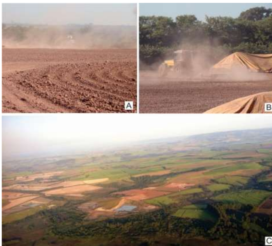
Figura 1.8 - Pátios de secagem e armazenamento de minérios. (A) - pátio de secagem nas proximidades da frente de lavra que é utilizado para secagem prévia do minério antes de ser transportado para a indústria. Durante o tempo em que o minério fica exposto à movimentação de máquinas e do próprio vento, produz apreciáveis quantidades de poeiras; (B) - Preparação do minério para transporte após secagem e estocagem; (C) - vista aérea mostrando a quantidade e extensão dos pátios de secagem apenas em parte da área do Campo do cocho.
