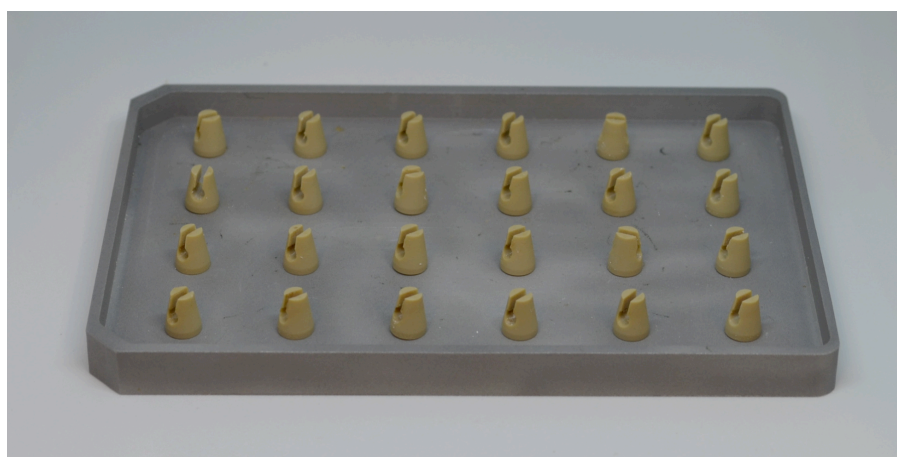
Figura 1 - Dispositivo utilizado para modelo de adesão de biofilme “Amsterdam Active”
