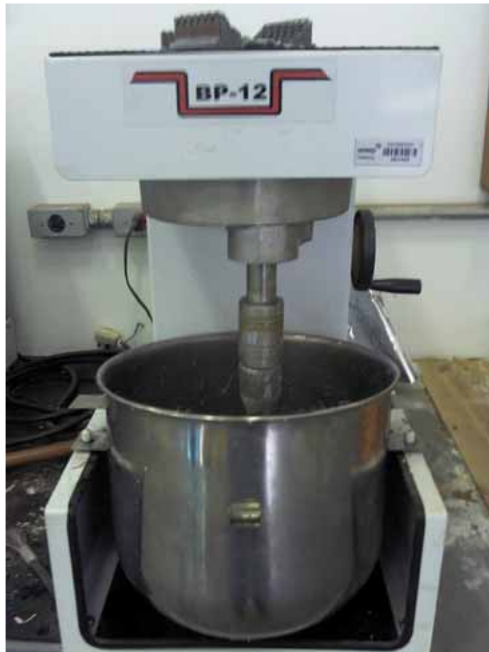
Figura 4- Batedeira planetária utilizada para a mistura dos materiais do compósito e água
