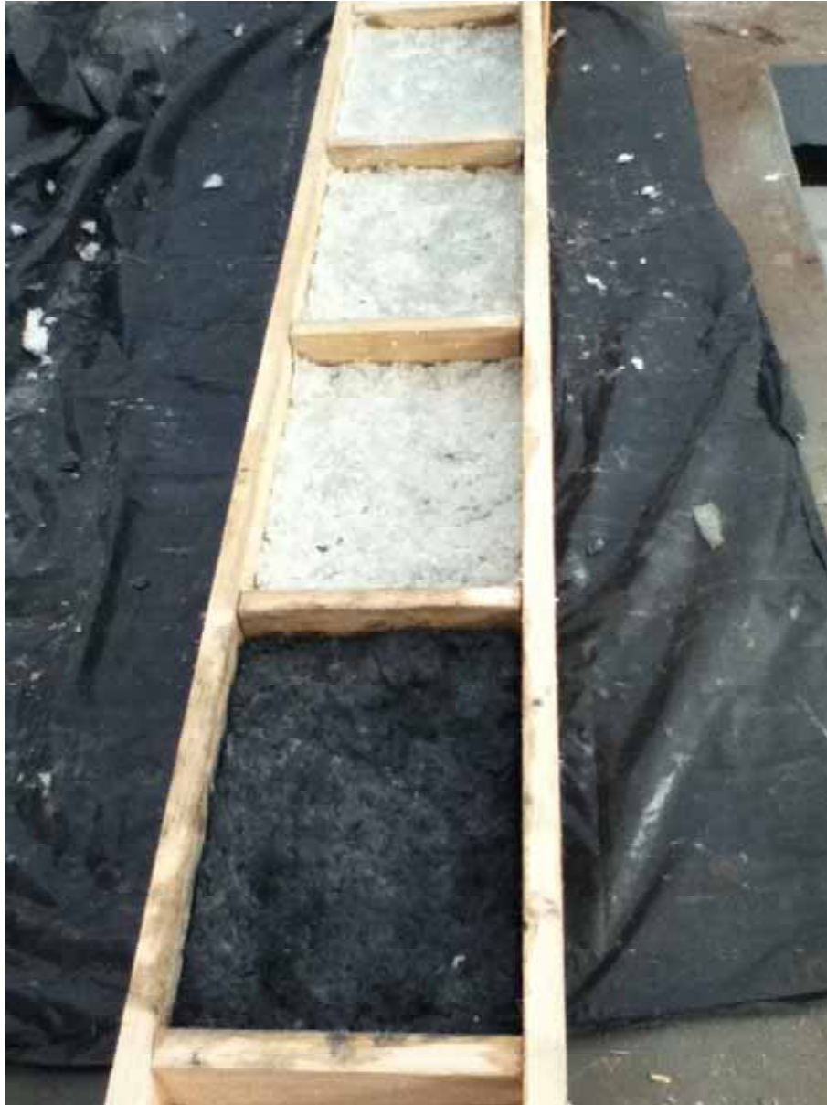
Figura 6- Moldes preenchidos com as misturas utilizadas para representar os quatro traços propostos
