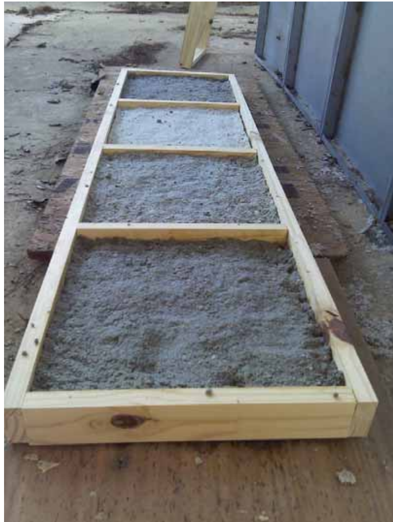
Figura 7- Moldes preenchidos com a mistura ainda úmida.
