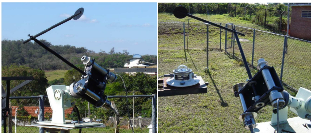
Figura 1: Pireliômetro Eppley, acoplado ao rastreado solar – Sensor detector da radiação solar direta na incidência.
