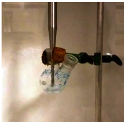
Figura 12. Sistema para realização da reação de racemização com \text{VOSO}_4 assistida por ultrassom
