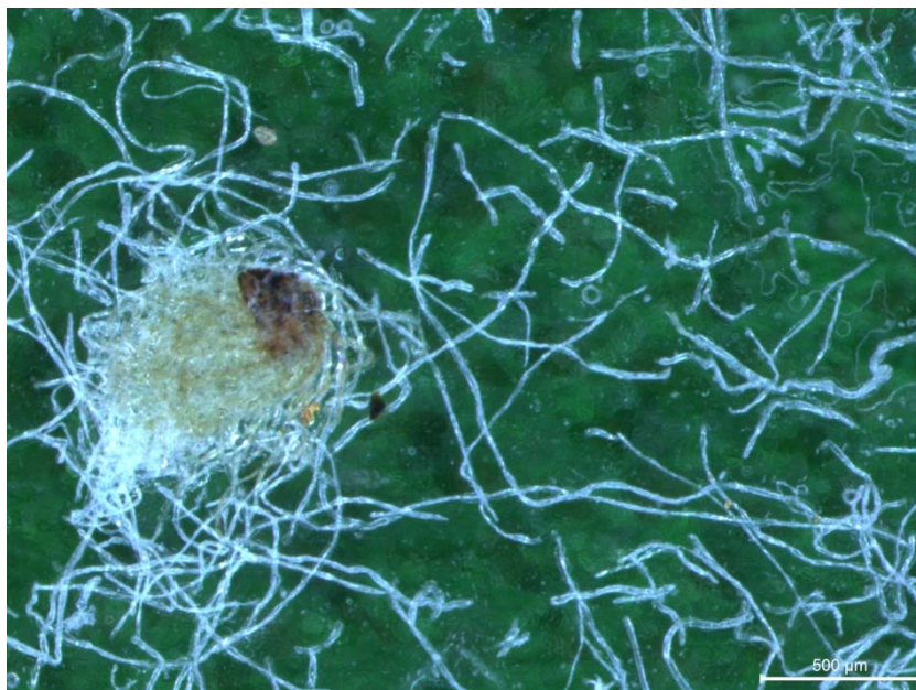
Figura 4. Linter residual alvejado 30, aumento de 500 μm.
