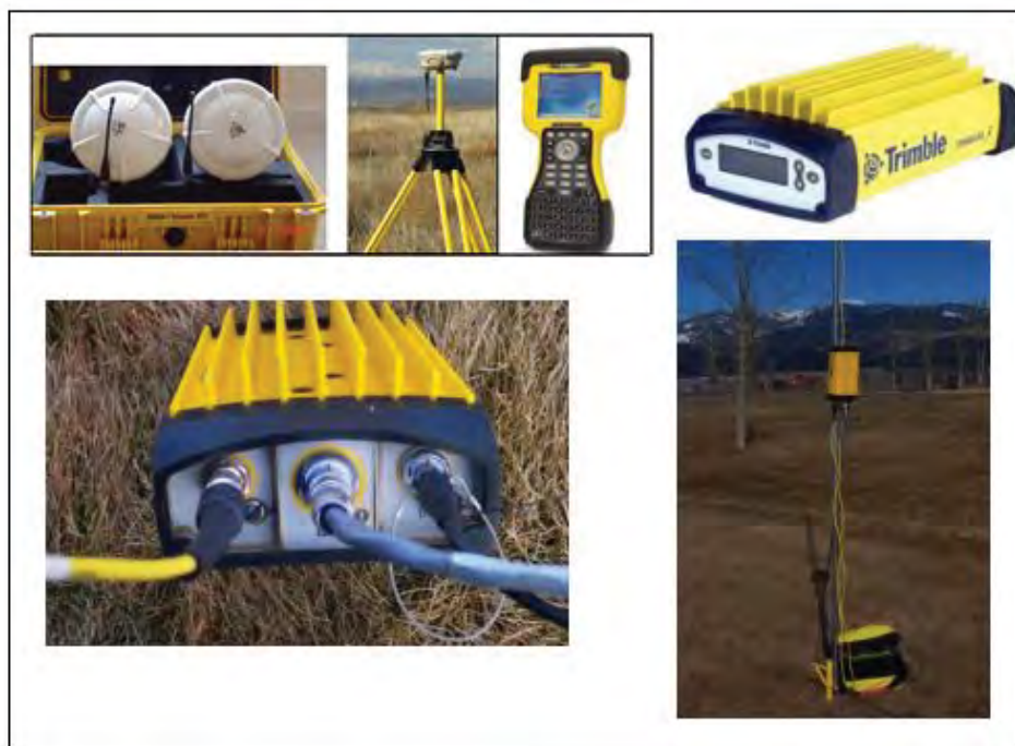
Figura 40 – R8 GNSS da marca Trimble, rádio externo Trimark 3, antena externa e coletora TSC2.
