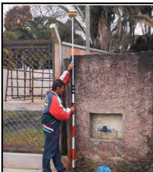
Figura 9 - Ausência de arborização e a altura da antena do receptor é maior que a edificação.
