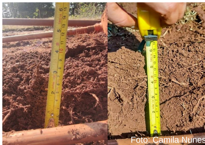
Figura 14– Variação na profundidade que os tubos gotejadores estavam enterrados
