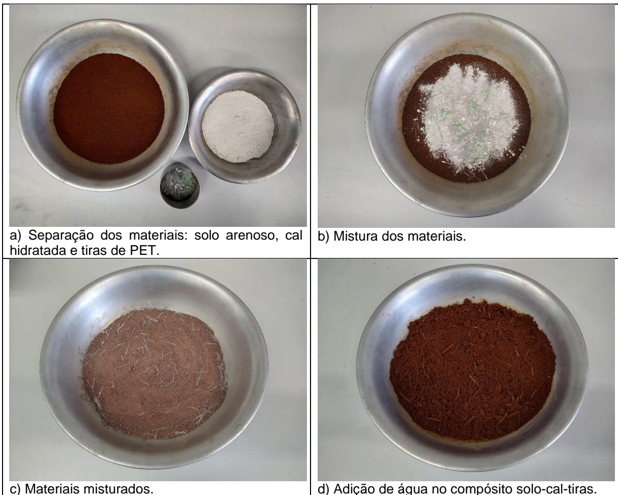
Figura 4.7 - Sequência de procedimentos para moldagem e ruptura dos corpos de prova.
