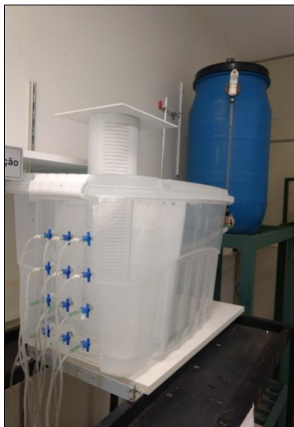
Foto 1. Equipamento simulando poço de monitoramento e baixo fluxo
