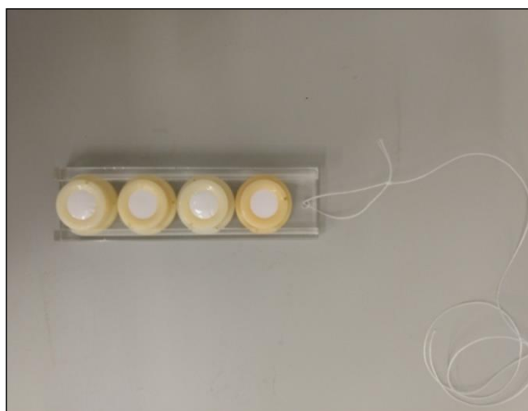
Foto 5- Dispositivos montados em duplicata prontos para serem submersos
