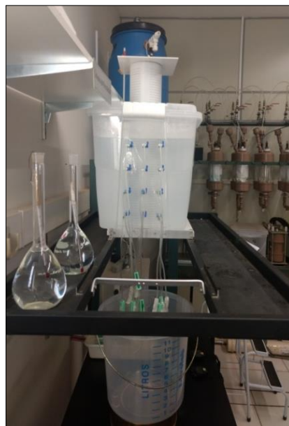
Foto 2. Equipamento simulando baixa vazão com a solução preparada
