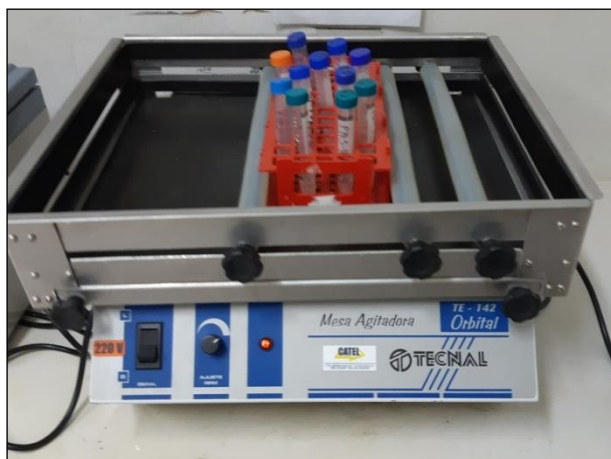
Foto 7 - Amostras na mesa agitadora para eluição por 24 horas.
