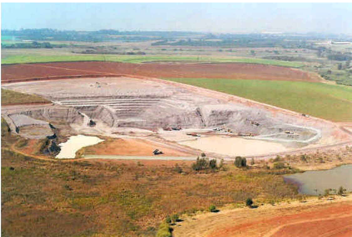
Foto 11: cava após a implantação do sistema de bancadas. Notar que há um número maior de bancadas que o de níveis individualizados, mas este é um recurso operacional para facilitar os trabalhos de lavra. O aumento relativo de custo de lavra é absorvido pelos ganhos em qualidade e versatilidade operacional já comprovados em produção.
