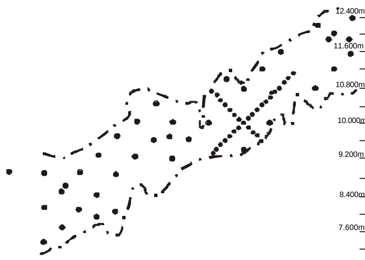
Figura 40: Padrão de malha de sondagem adequado para definir os padrões variográficos à pequena escala (curta distância). Notar a amostragem em cruz sugerida para um trecho selecionado do depósito mineral. Modificado de David (1977).
