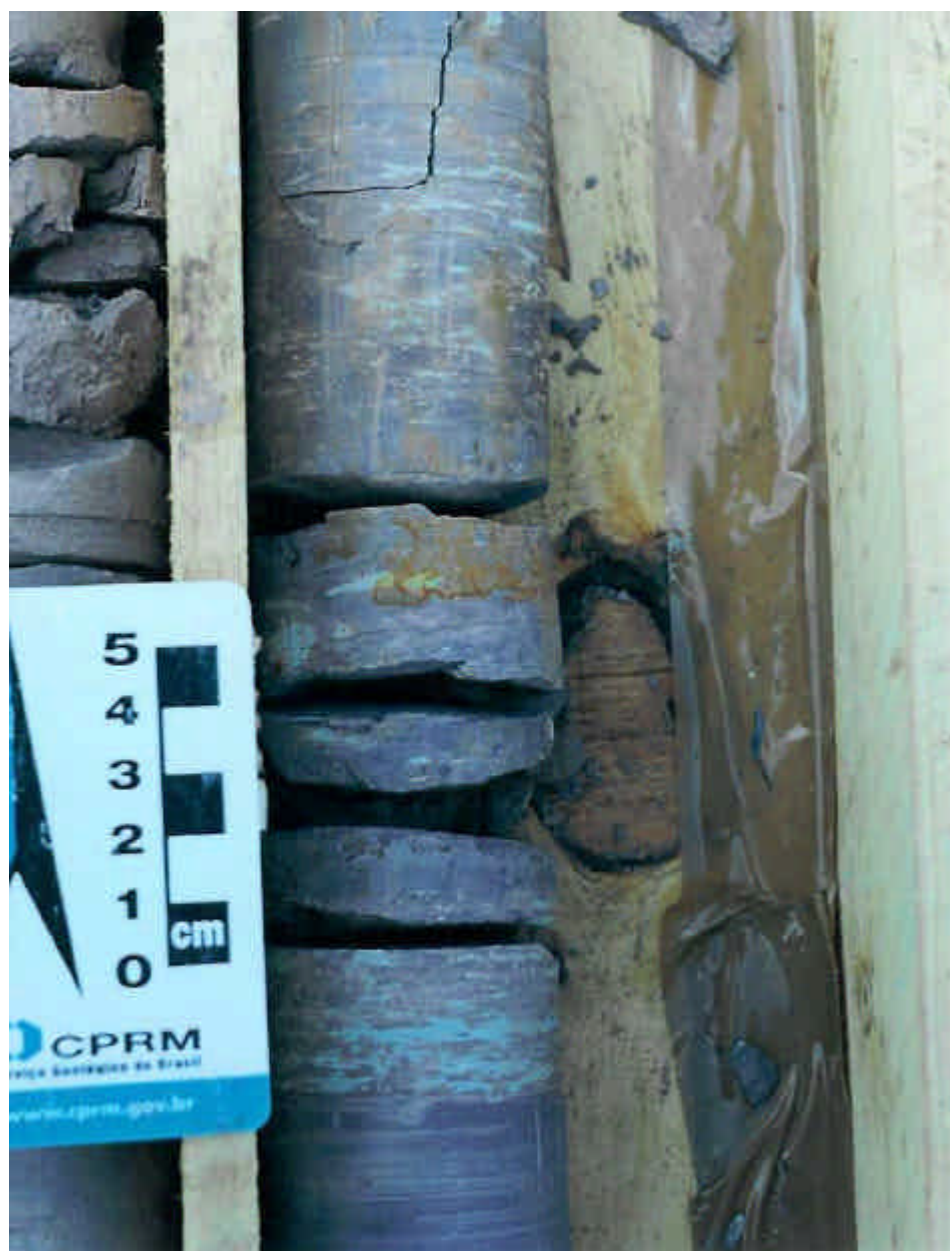
Foto 14: Trecho com testemunho de sondagem rotativa em diâmetro Nx.
