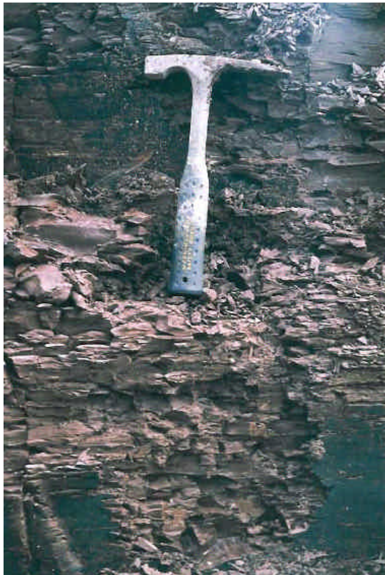
Foto 09: Detalhe da camada 2a, constituída por siltitos médios a finos, mais úmidos e mais porosos que os da camada 2b.
