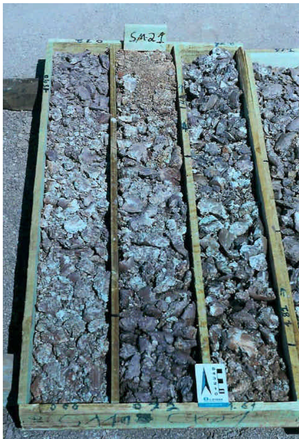
Foto 13: Sondagem a trado do furo sm 21. Trecho de 0,0 a 2,36m. Notar em 1,48m passagem por veio de sílica semelhante ao da foto 08 tirada na frente de lavra.
