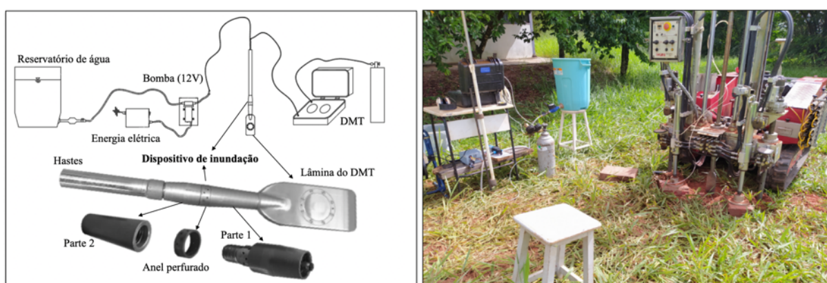
Figura 4.9 – Detalhe esquemático do dispositivo de inundação desenvolvido por Rodrigues (2021).
