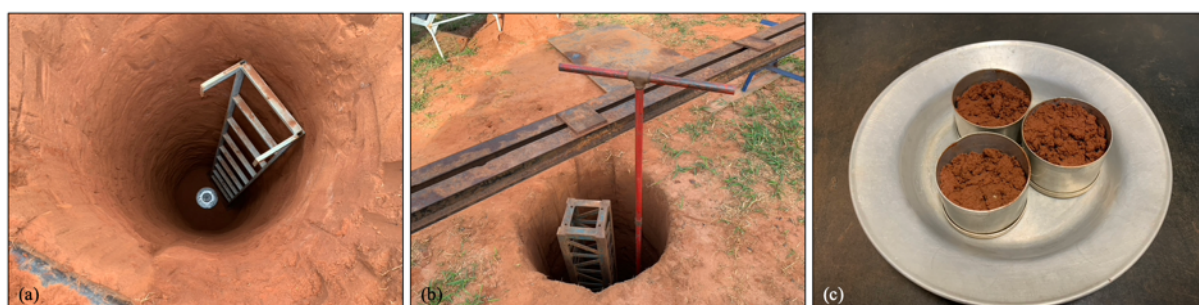
Figura 5.5 – (a) Poço aberto para desmontar ensaio e coletar amostra; (b) coleta de amostra por meio de trado; (c) detalhe de amostra coletada.
