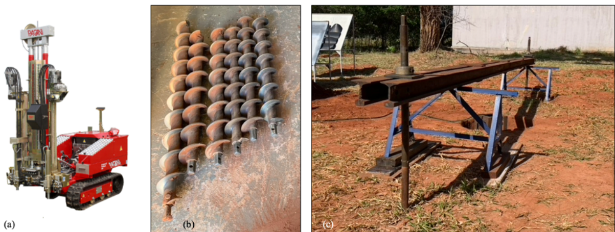
Figura 5.2 – (a) Sistema multifunção; (b) hastes de ancoragem; (c) sistema de reação montado em campo.
