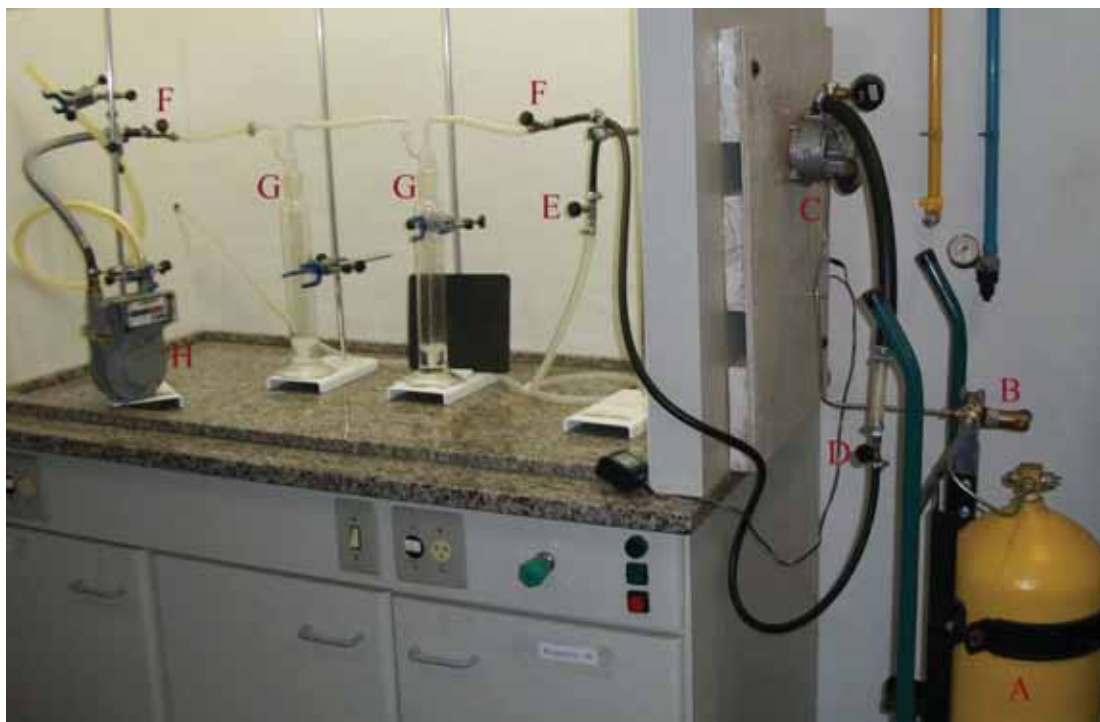
Figura 8 – Sistema para amostragem de GNV. A – cilindro para GNV de alta pressão (7 m 3 ); B – Válvula em “T” de engate rápido para abastecimento e fornecimento de GNV para o sistema; C – Redutor de pressão KGM de três estágios; D – Válvula da entrada de amostra de GNV à baixa pressão; E – Válvula de controle para nitrogênio; F – Válvulas de controle para isolamento; G – Frascos lavadores de gás (500 mL); H – Medidor de volume de GN.
