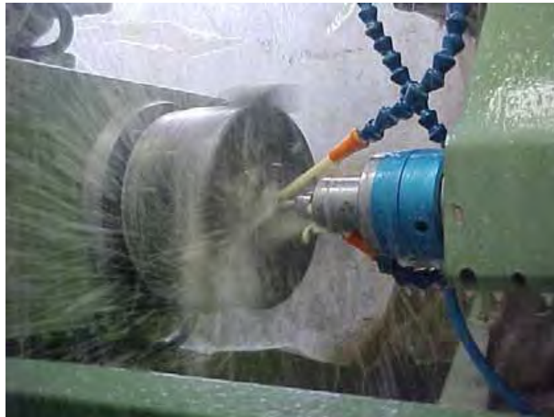
Figura 28- Operação de retificação interna empregando-se a técnica convencional de lubri-refrigeração.
