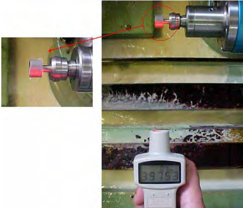
Figura 26- Medição da rotação do cabeçote retificador.
