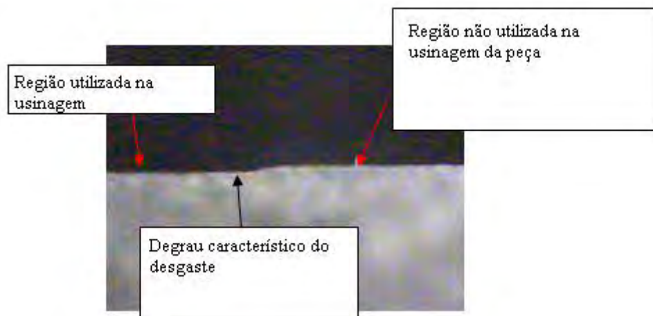
Figura 32- Degrau característico do desgaste do rebolo fotografado através de um microscópio.
