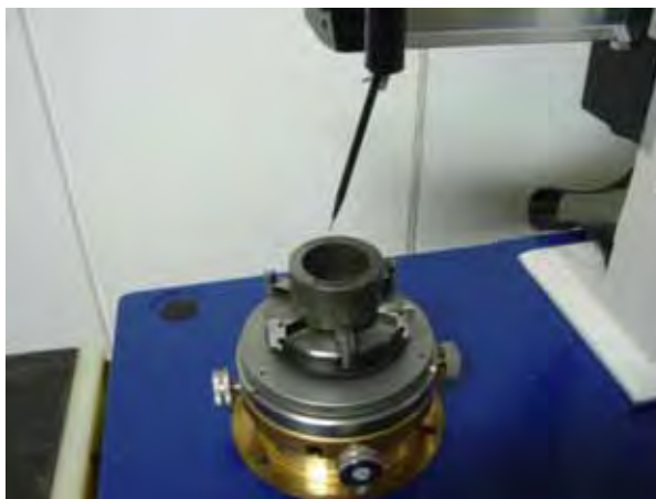
Figura 31- Medição dos desvios de circularidade da peça retificada.
