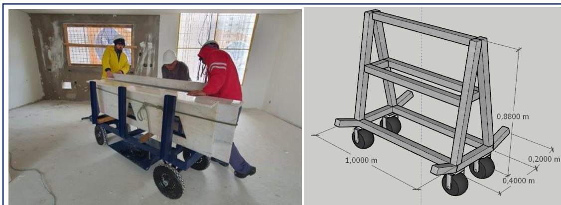
Figura 23 - Carrinhos de transporte de bancadas, pisos cerâmicos e forro de gesso
