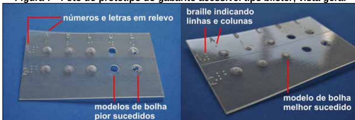
Figura 7 - Foto do protótipo do gabarito acessível tipo blister , vista geral
