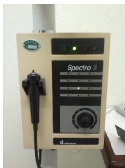
Figura 6: Seletor do tempo de exposição e disparador do equipamento de raios X.
