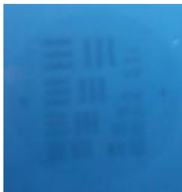
Figura 16: Foto da imagem do filme radiográfico obtido no teste de ponto focal.
