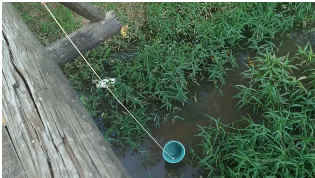
Figura 4.1. Utilização do balde acoplado a corda para coleta de amostras em áreas de difícil acesso (ponto IL-14).
