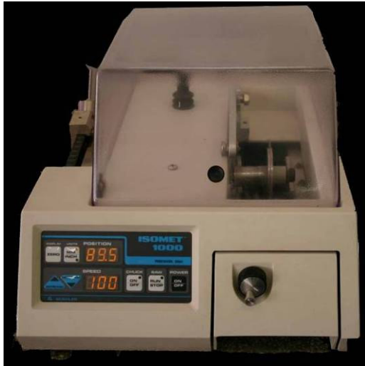
FIGURA 10 - Máquina de corte seriados de baixa deformação Isomet 1000 (Buehler Lake Bluff, IL, USA)
