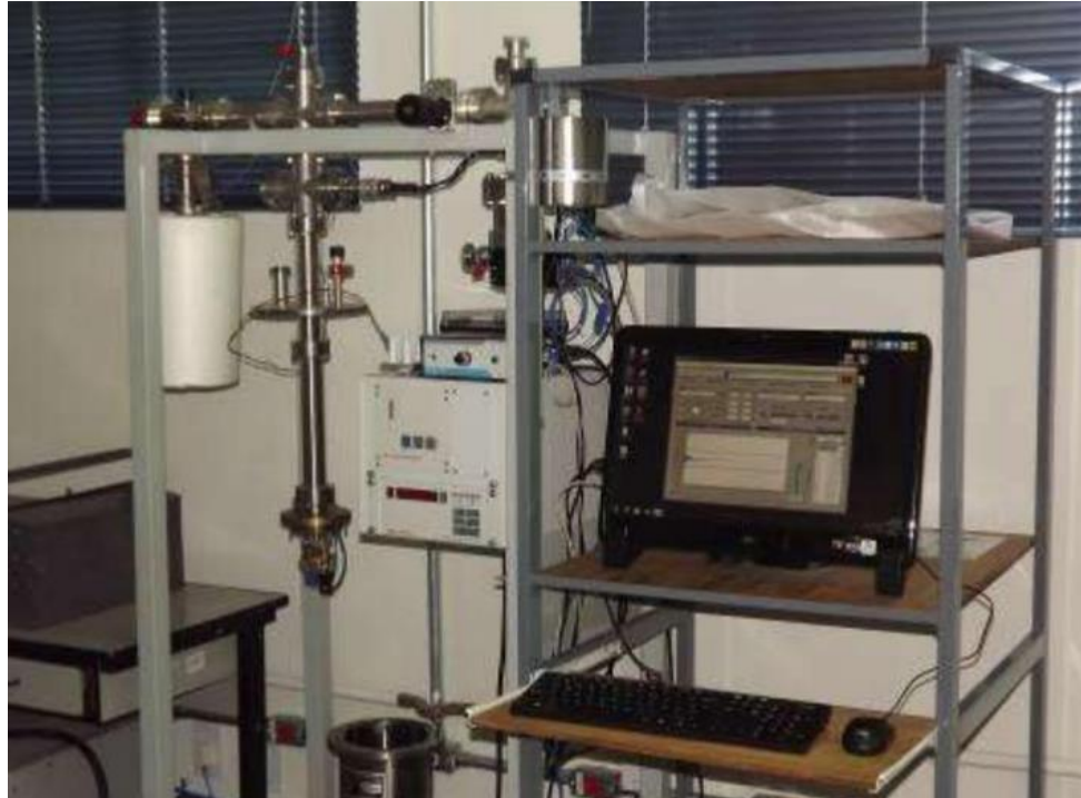
Figura 15 – Fotografia do equipamento utilizado para as medidas de Módulo de Elasticidade.
