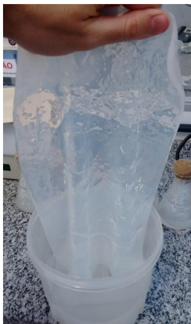
Figura 9. Manta de CB com 3 dias de crescimento, após o processo de purificação e neutralização.
