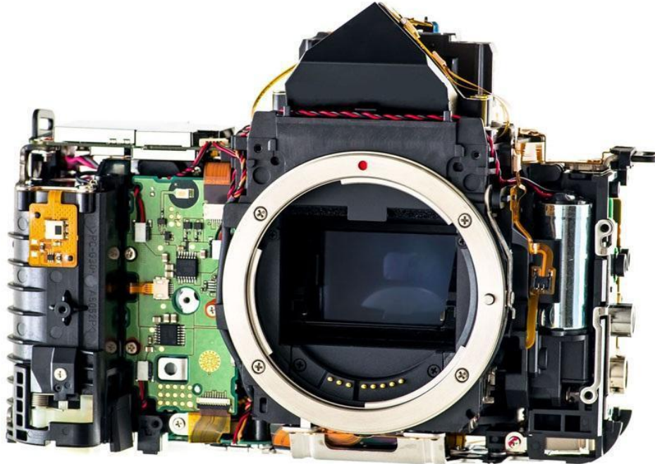
Figura 1 - Imagem da parte interna do circuito eletrônico de uma câmera digital
