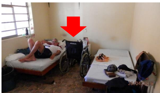
Figura 71 – Espaço entre as camas insuficientes para manobras de cadeira de rodas (360°) na ILPI II.
