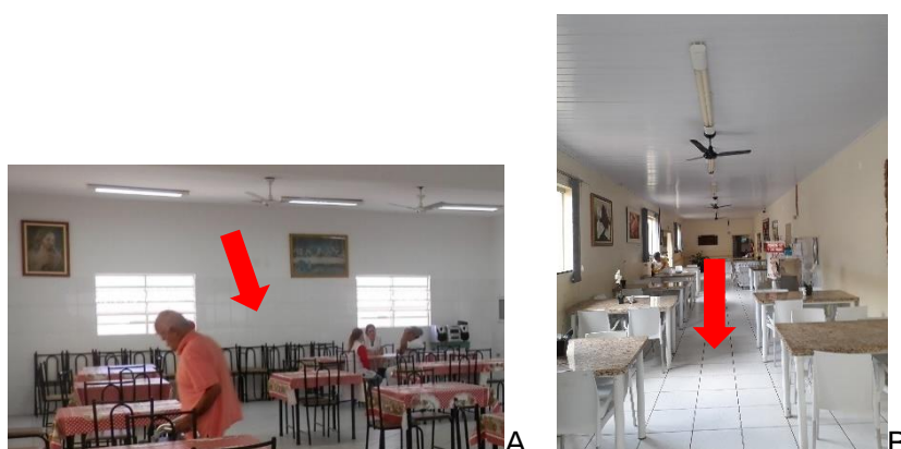
Figuras 61 A e B - Mobiliário amontoado obstruindo acesso a janela (A) e espaço de circulação inadequado para usuários de cadeira de rodas (B).
