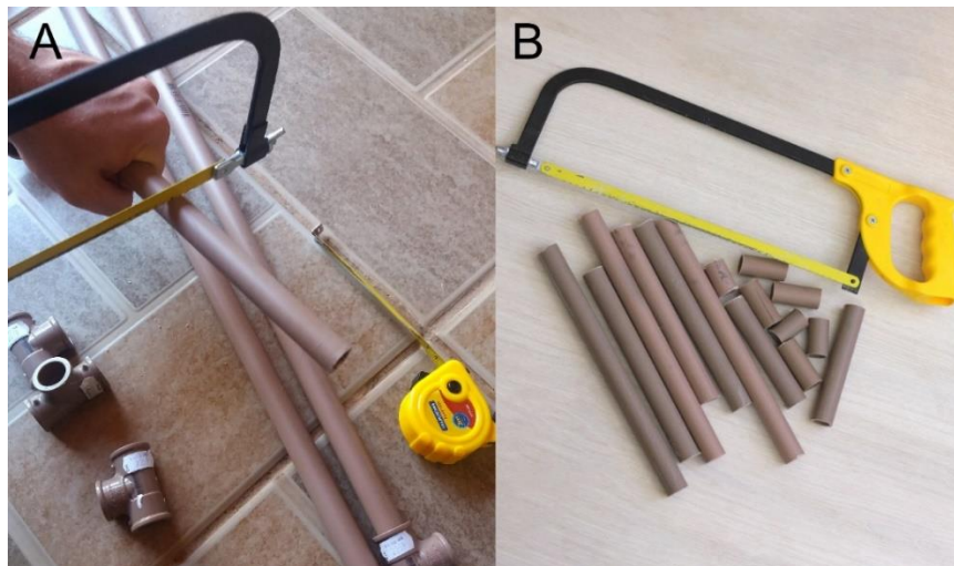
Figura 38. A: Corte com serra manual; B: Peças cortadas conforme as medidas.
