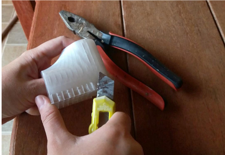
Figura 50. Remoção do suporte com estilete e alicate.
