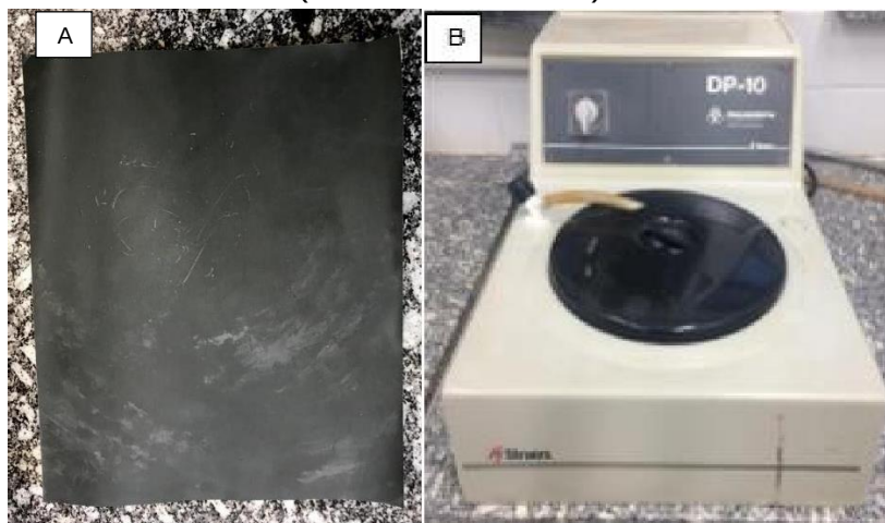
Figura 5 – (A) Lixas d'água de granulação (600, 1200, 1500); (B) Politriz DP-10 (Panambra Struers).
