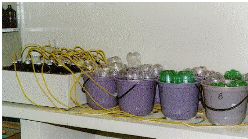
Figura 3. Garrafas com líquido ruminal colocadas em banho-maria e recipientes confeccionados para o armazenamento dos gases produzidos
