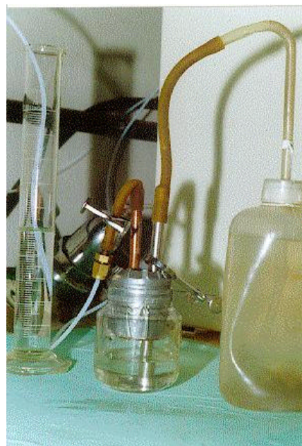
Figura 7. Recipiente de transferência após a injeção do gás no cromatógrafo gasoso pelo acréscimo de água no mesmo.
