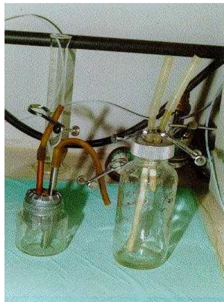
Figura 5. Recipiente utilizado para a transferência do gás armazenado para o cromatógrafo gasoso (esquerda) em comparação ao utilizado para a transferência dos gases oriundos de biodigestores (direita).
