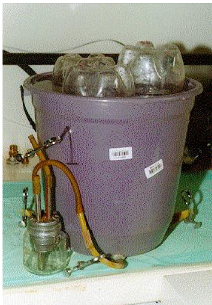
Figura 4. Recipientes confeccionados para o armazenamento dos gases produzidos no processo fermentativo “in vitro”.
