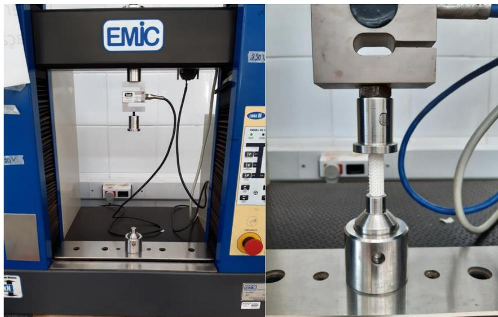
*Figura 30 – Máquina Universal de Ensaios e Setup dos Ensaios. Fonte: dados do autor*
