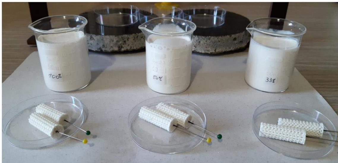
Figura 25 - Preparação do Ensaio de Recobrimento com Látex. Fonte: dados do autor
