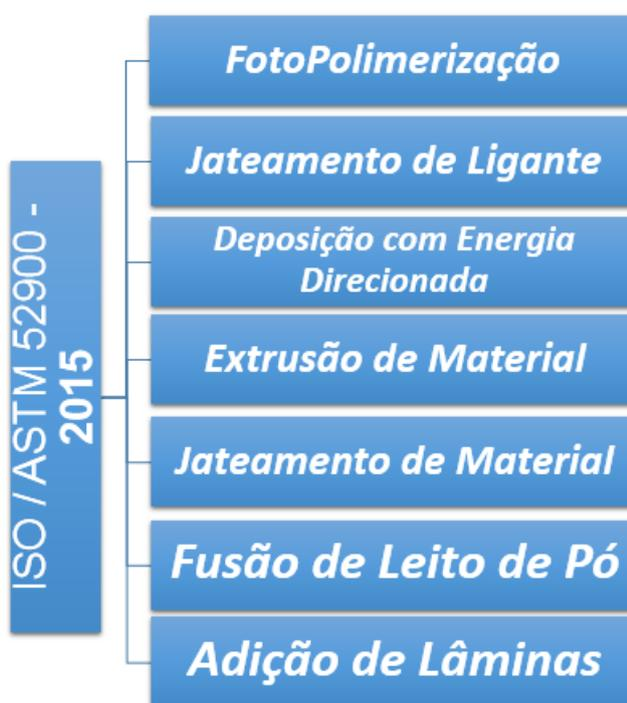
Figura 5 - Classificação MA – ISO / ASTM 52900. Fonte: adaptado de ISO / ASTM 52900 (2015)
