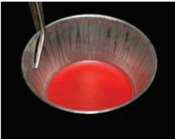
Figura 9: Cera de moldagem acondicionada em um recipiente metálico para ser fundida até o estado líquido.
