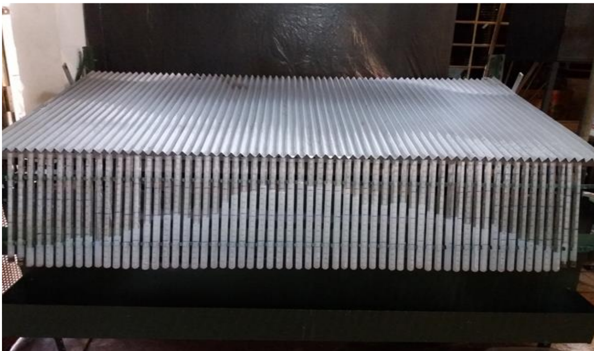
Figura 4. Perfil de distribuição volumétrica de calda aspergida por ponta de pulverização defletora (TT 110015), detalhado em tubos de coleta componentes de mesa de deposição.
