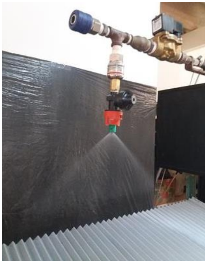
Figura 5. Detalhe do jato cônico vazio de uma das pontas de pulverização avaliadas (TXA 80015), no estudo da distribuição em mesa de deposição, com distância de 50 cm entre a ponta de pulverização e a superfície da mesa.
