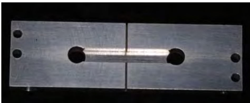
Figura 11 -Estrutura bipartida metálica criada para permitir o enceramento padronizado das barras que compuseram os grupos estudados diretamente sobre o modelo mestre (parte A e parte B unidas).
