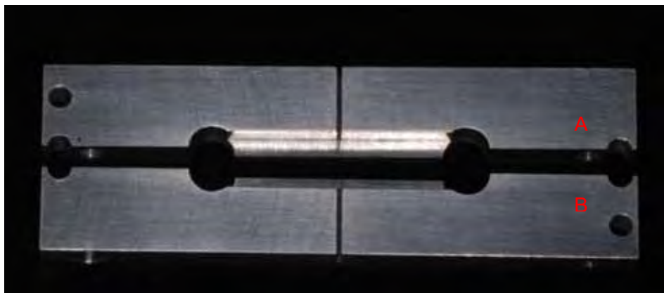
Figura 10 -Estrutura bipartida metálica criada para permitir o enceramento padronizado das barras que compuseram os grupos estudados diretamente sobre o modelo mestre (parte A e parte B separadas).
