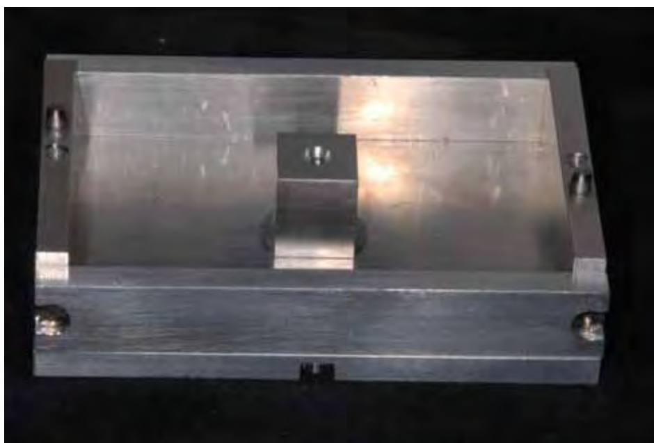
Figura 2 -Matriz metálica montada.
