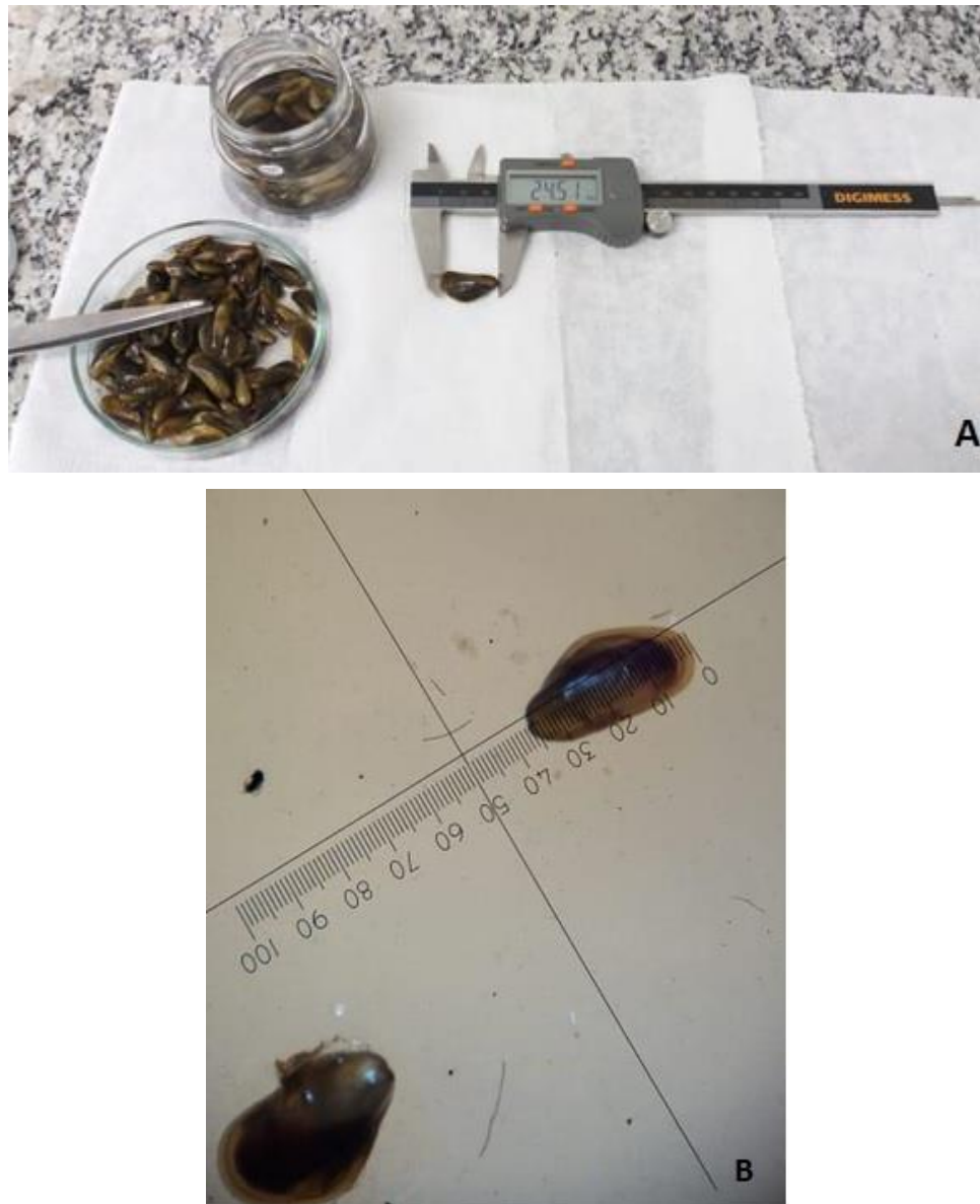
Figura 10. Medição do mexilhão-dourado em laboratório: Paquímetro digital (A) e Microscópio estereoscópico (B).
