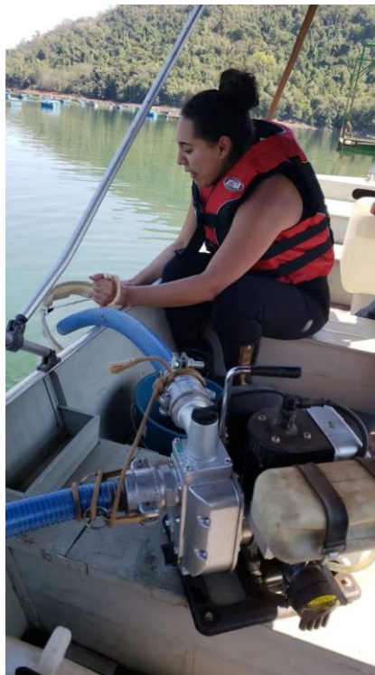
Figura 7. Amostragem de zooplâncton, utilizando bomba de sucção e rede de plâncton.
