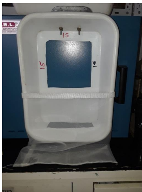
Figura 9 – Bandeja para amostragem de mexilhões aderidos à substrato artificial, com gabarito e tela de nylon de 40 \mu\text{m} .
