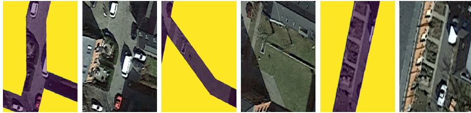
Figura 29 – Erros nas máscara de vias disponibilizadas por Kaiser et al. (2017)
